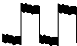
Обычное изображение сигнала в режиме пиковой детекции
